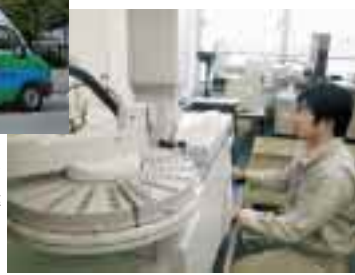
水の中の成分とその量を測定できる「ガスクロマトグラフ質量分析装置」及び環境測定車
