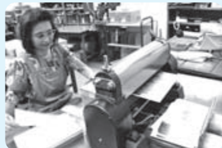
点字を打った亜鉛版に紙を挟み、機械を通して圧力をかけ、1枚ずつ手作業で作成しています。
