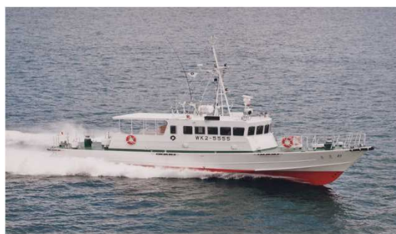
漁業取締船「みさき」平成14年7月竣工 総トン数39トン 最大速度45.8ノット
