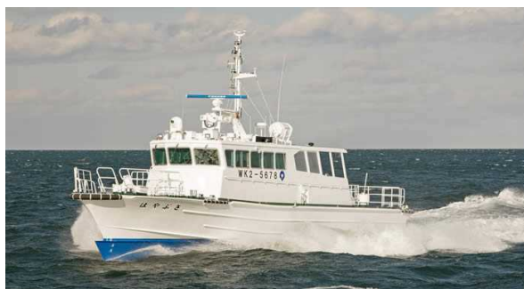
漁業取締船「はやぶさ」平成28年12月竣工 総トン数38トン 最大速度36.0ノット
