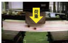
曲げ方式によるせん断強度試験
