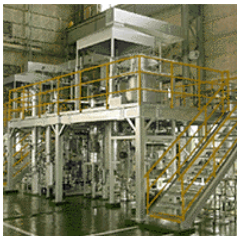
図表 V-12 バイオマスガス化メタノール製造システム 240kg/日試験装置外観
