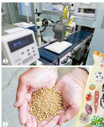
①多くの旨みと栄養がありながら、糠と一緒に取り除かれていた非常に薄い層の「亜糊粉層（あこふんそう）」を。亜糊粉層を残した金芽米を作るには、熟練したオペレーターの技術が必要で、目視により精米しすぎるのを止めるという。②精米機器メーカーとして活躍する東洋ライス。環境に対するこだわりが広く認められ、現在は国内50もの精米工場にBG無洗米加工機を供給している。③④BG無洗米のBGとは、ブラン(Bran)＝ヌカ、グラインド(Grind)＝削るという意味。米の表面についた糠を糠で削り取るという製法だ。米の精はBG無洗米の副産物、肌ヌカから生まれた有機質肥料。
