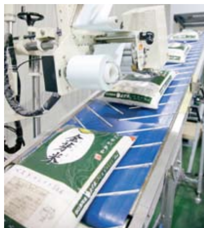
玄米を投入し、精米からBG加工、自動包装までフルオートメーションで行われる工場は、徹底した衛生管理が行われている。 ※BGとはヌカで(Bran)米を研ぐ(Grind)製法
