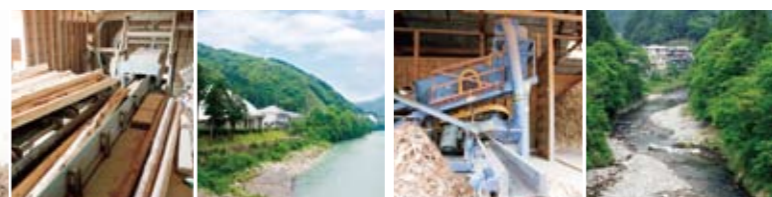
左／非常に細かいパウダー状の木質バイオマス。このパウダーを従来の燃料のように噴射、燃焼させる。中／まずは残材を粉碎し、更にパウダー状にしていく。右／目の前を日高川が流れるきのくに中津庄（日高川町）。他にも愛徳荘や中津温泉あやめの湯鳴滝で同様の木質バイオマスを利用している。 左／龍神村森林組合間伐材流通センターに設置されている、木質生チップを作る装置（チップパー）。右／美人の湯として有名な龍神温泉（田辺市龍神村）。季楽里龍神はこの温泉街から少し離れた山間にひっそりと佇んでいる。
