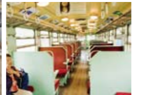
のどかな風景の中をゆっくりと走る紀州鉄道。下の写真は休車となったキハ603の車内。木の床に天井の電燈、対面式のシート。今も紀伊御坊駅の車庫に大切に保管されていて鉄道ファンが訪れる。キハも現在のレールバスと同じ2軸4輪である。
