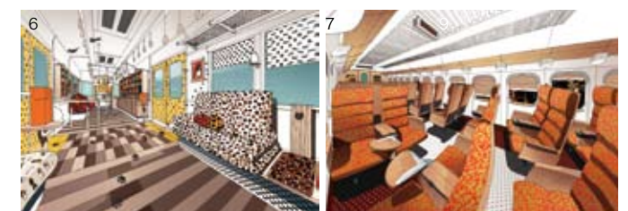
6.たま電車開発途中の内装予想図。車内の床も木を用い、シートにもオリジナルのデザインを施している。7.関西と九州を直結する新幹線「つばめ」の車内予想図。肘掛けなどに木を用いている。
