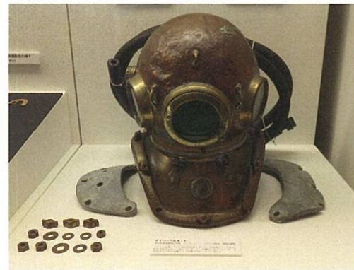
初期のダイバーが使用していたヘルメット 空気を送る送風パイプが付けられている。 串本町教育委員会蔵(データ提供: J I C A 横浜海外移住資料館)
